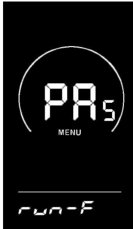
8-6 A segédérzékelő irányának beállítására szolgáló interfész
